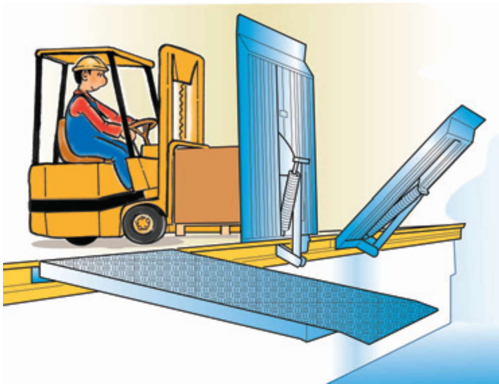
Banchina di carico esterna equipaggiata con pedane di carico basculanti a traslazione laterale
